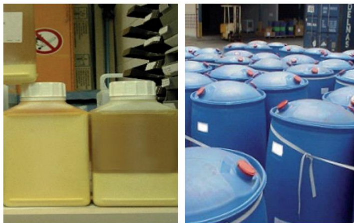
FIGURA 3 – Precipitação de produtos e estufamento de bombonas devido à contaminação microbiológica.
